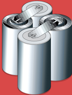
Conectare în serie, bloc simetric
