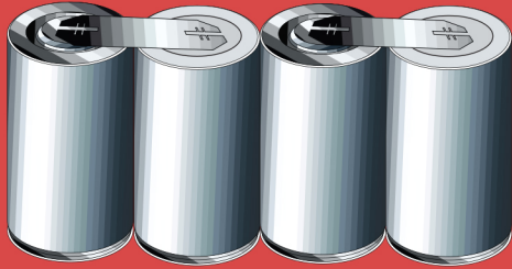
Conectare în serie, așezare celule alăturate
