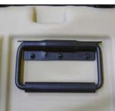
MANERE SUPLIMENTARE (3 SI 4 GAURI) Maner cu oprire la 90°. Otel placat negru sau otel inoxidabil (finisaj negru). 3 gauri: capacitate de ridicare 15 kg per maner 4 gauri: capacitate de ridicare 68 kg per maner
