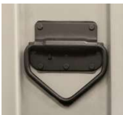
INELE DE RIDICARE / DE ANCORARE Manere de ridicare cu diametrul de 2" (50 mm), cu arc, pivotare la 180°, (capacitate de 340 kg per inel instalat) sau (453 kg per inel). Realizate din otel placat si otel inoxidabil.
