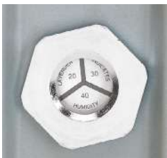
INDICATOR UMIDITATE Indica intervalele de umiditate relativa de 20%, 30% si 40%. Culoarea se schimba atunci cand umiditatea internă depaseste nivelul indicat. Revine la starea initiala pe masura ce umiditatea scade; se utilizeaza impreuna cu PRV.
